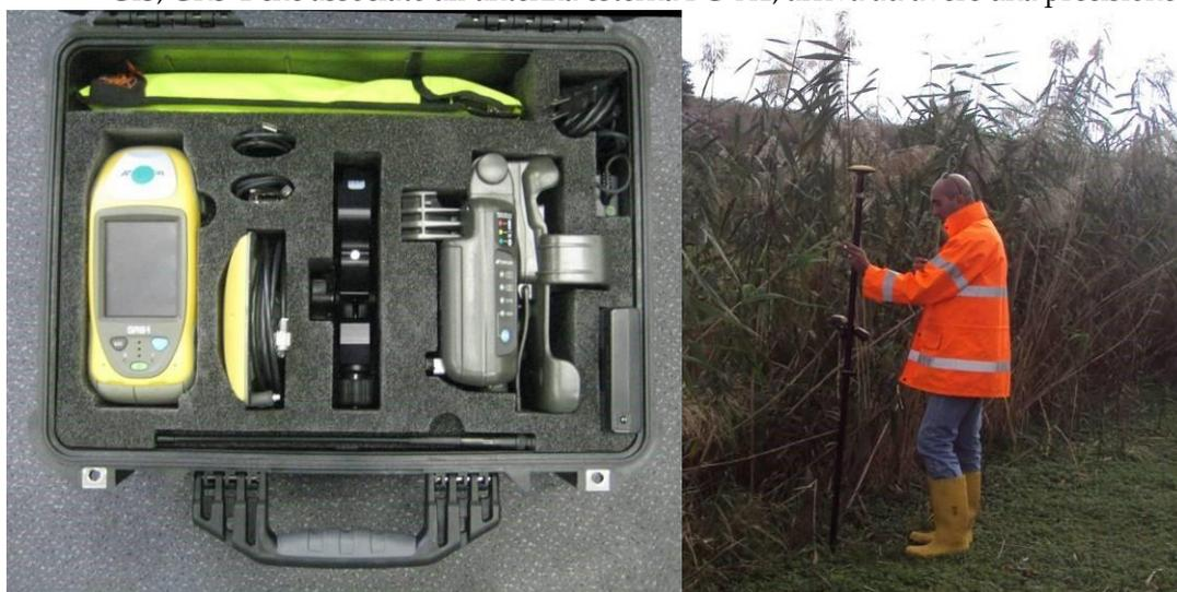
**Figura 3.1.1** - Kit del ricevitore palmare GNSS con antenna PG-A1 associata
