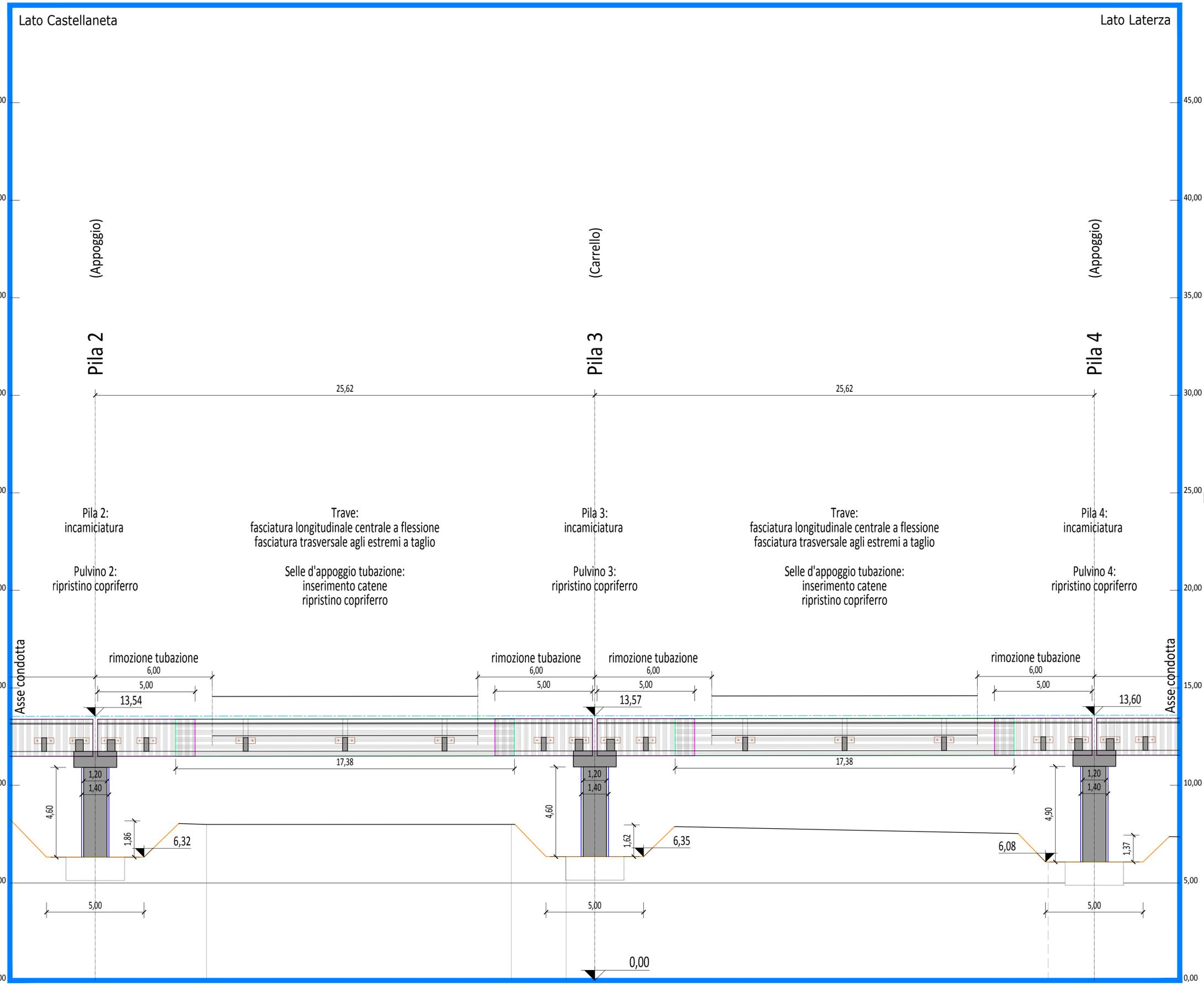
Profilo longitudinale dalla Pila 2 alla Pila 4
