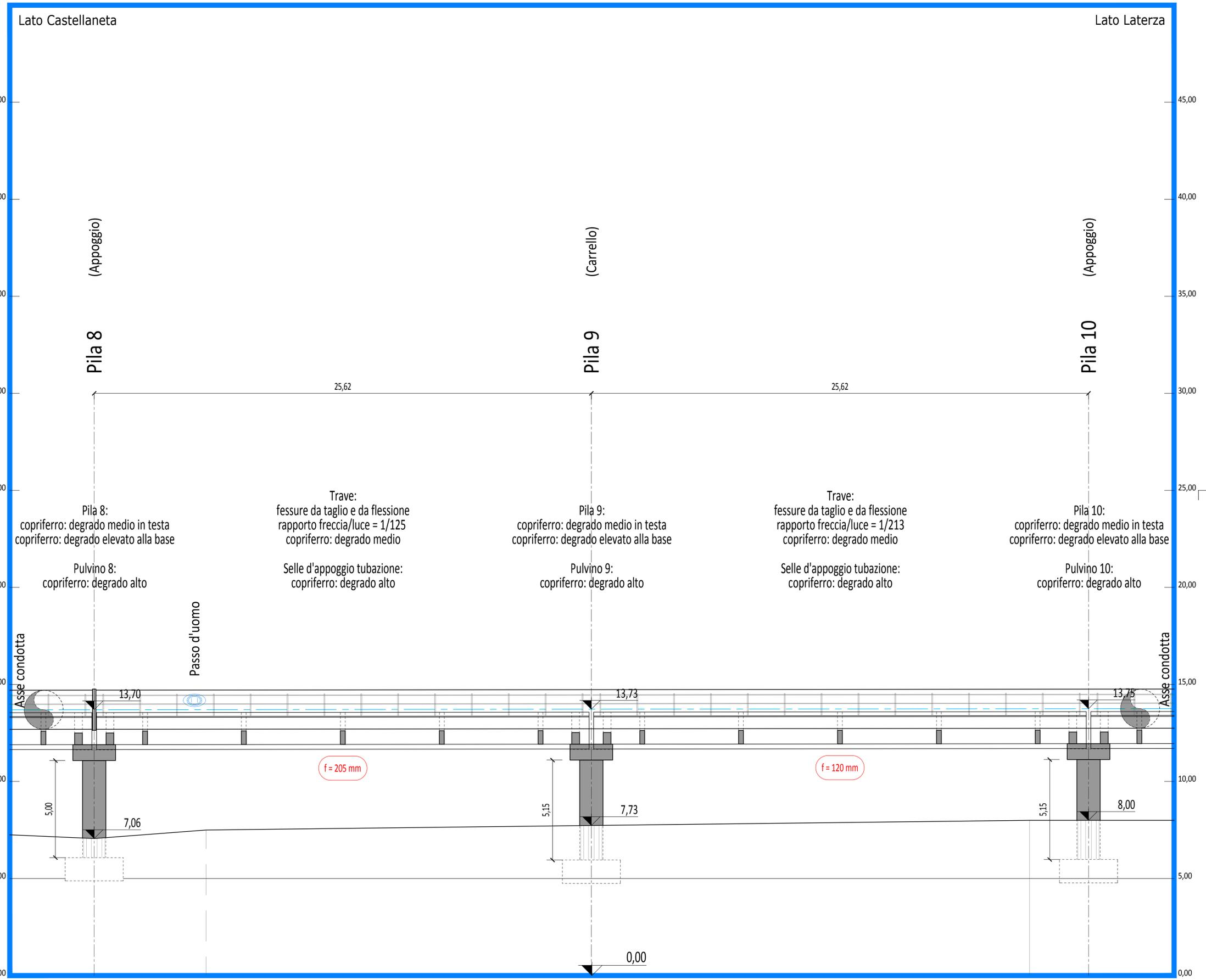
Profilo longitudinale dalla Pila 8 alla Pila 10
